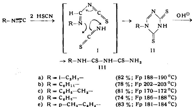
Die Bildung von II vollzieht sich wahrscheinlich durch cyclische 1,4-Addition von Rhodanwasserstoffsäure an das Rhodanwasserstoffsäure  $\alpha$ -Addukt des Isonitrils (I).
